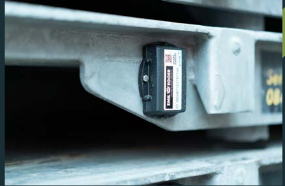
GPS-Tracker an Pritsche installiert
